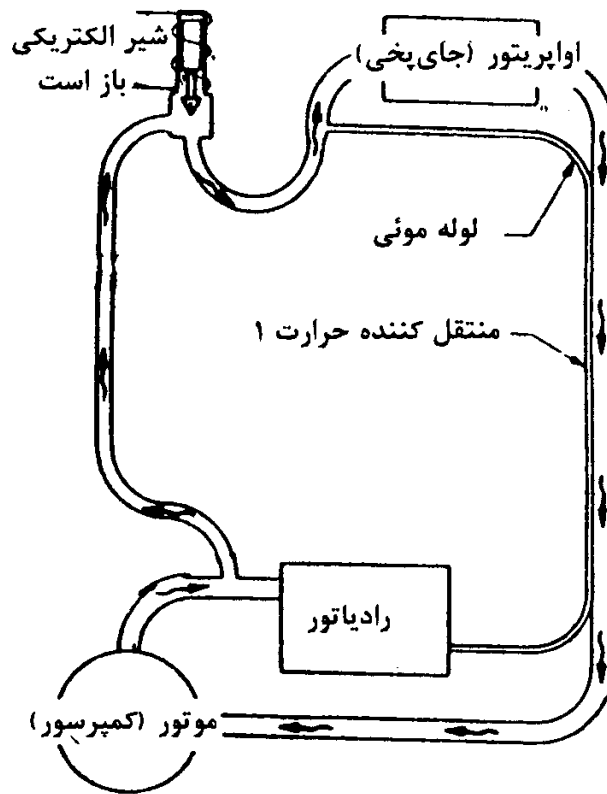
شکل ۱۷-۳۰ دیفراسست گازی شیر سولنوئیدی با دو مسیر
