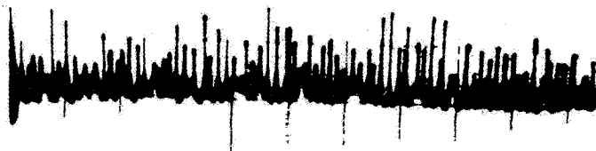
شکل ۲.۸ رفتار زمانی نمونه‌ای اولین لیزرهای حالت جامد با دمش پیوسته موج (cw) در اوایل توسعهٔ لیزر، مقیاس زمانی 50 \mu\text{s}/\text{div} است [۳].
