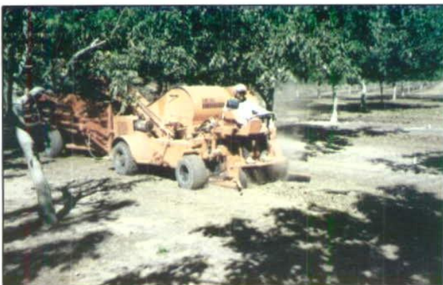
شکل ۳- دستگاه جمع‌کننده گردو از زیر درخت
