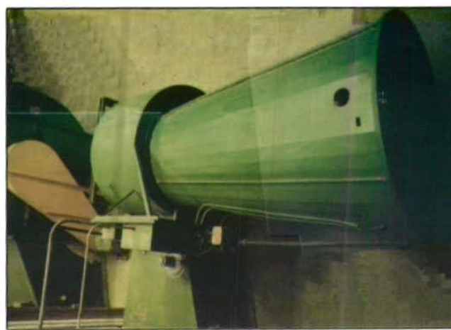
شکل ۱۱- سیستم گرم‌کننده هوای گرم خشک‌کن
