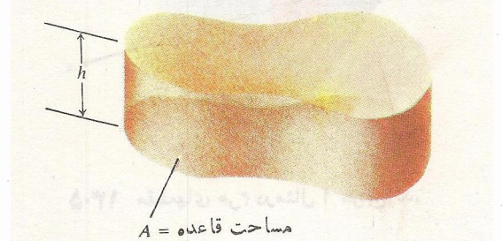
۱۵.۵ حجم استوانه ای نظیر این استوانه معمولاً به صورت Ah تعریف می شود.
