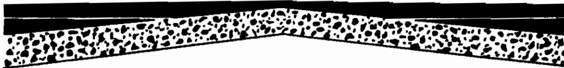
شکل ۳-۶ روش صحیح کاستن شیب عرضی روسازیها
