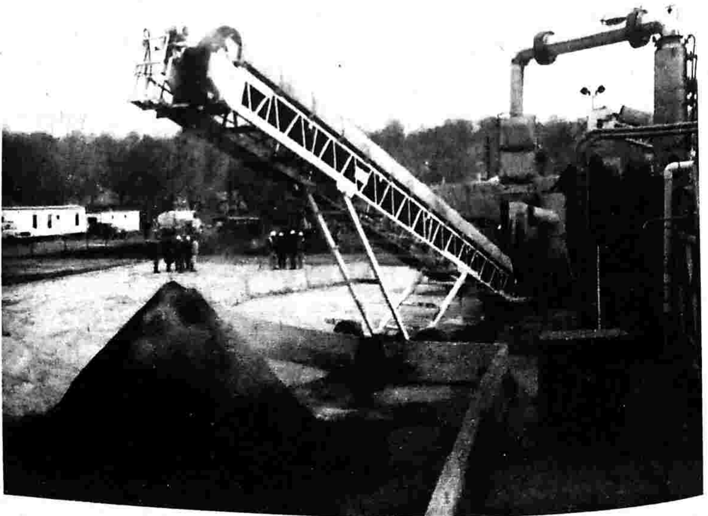
خاک آلودگی زدای شده از تسمه نقاله دستگاه تصفیه حرارتی در مکان آلوده به PCB های سوپرفاند سرازیر می شود.
