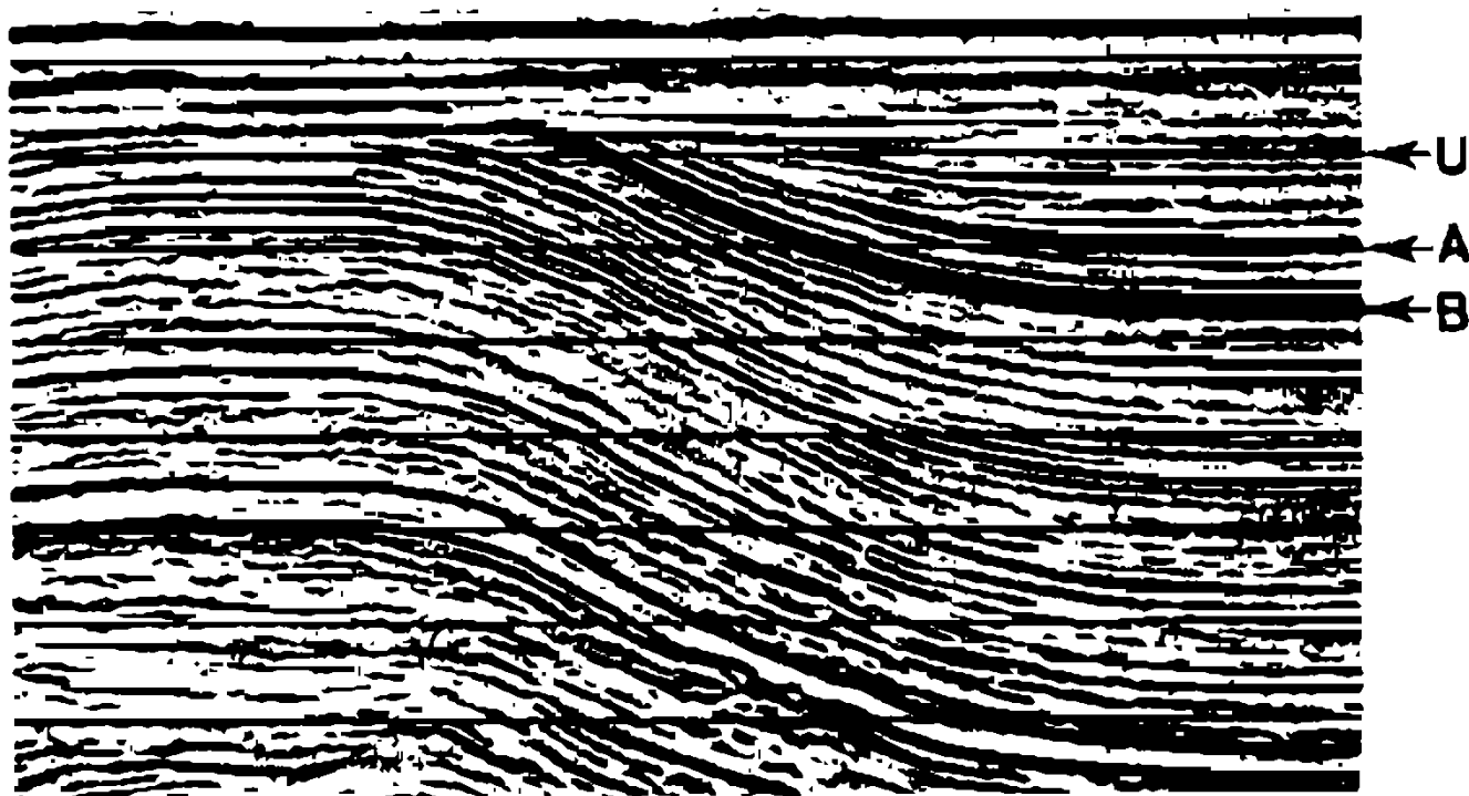
شکل ۸-۵۷ - مقطع لرزه‌ای از یک نفتگیر باریک شده (A) و یک نفتگیر قطع شده (B) در زیر یک ناپیوستگی (U)
