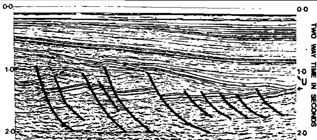
شکل ۸-۵۶ - پدیده onlapping (بین دو فلش) بر روی یک سطح ناپیوستگی
