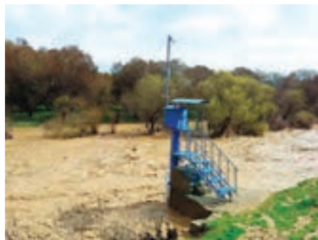
شکل ۲-۳- ایستگاه اندازه‌گیری آبدهی رود
