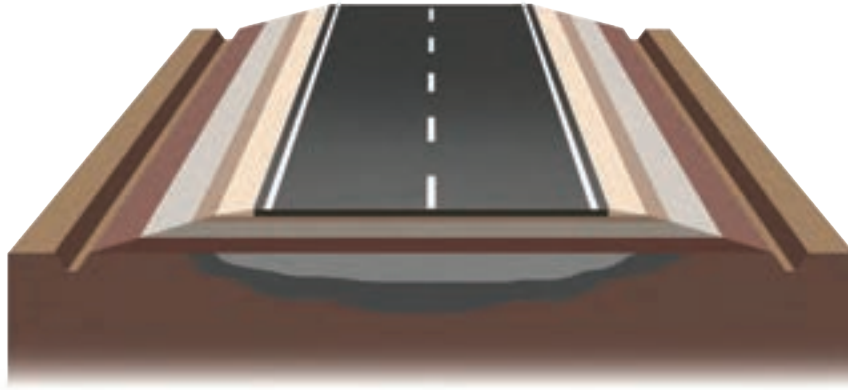
شکل ۱۰-۴. لایه های مختلف راه بر روی بستر طبیعی
