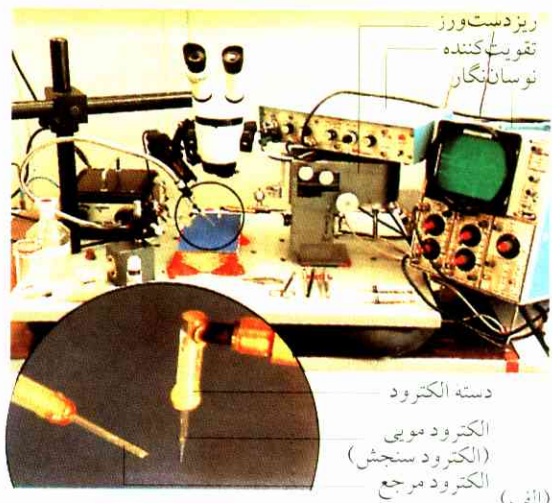
شکل ۱ الف) تنظیمات آزمایش فیزیولوژیایی به منظور اشتقاق درون‌یاخته‌ای؛ ب) طرح روند فشار الکتریکی در ضمن فروکردن نوک الکتروود مویی در یاخته (آکسون طولیل) دیده می‌شود.
