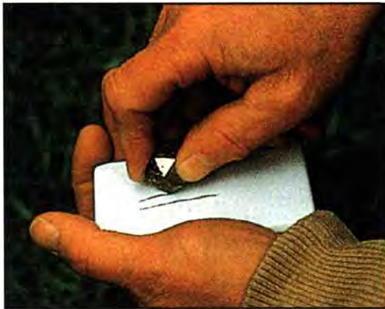
پیریت طلایی روی صفحه چینی خط ناشی از خراش سیاه ( سیاه متمایل به سبز) باقی می‌گذارد.
