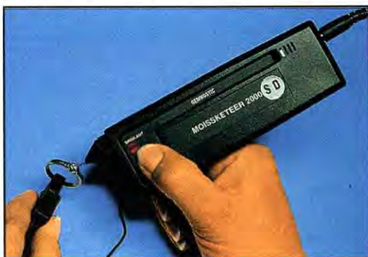
وسیله شناسایی مویزنایت که براساس انتقال حرارت کار می کند.
