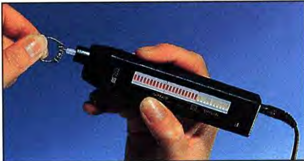
دستگاه انتقال حرارت برا شناسایی الماس از مویز نایت.
