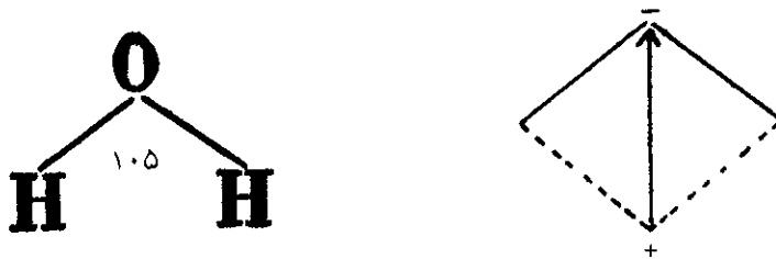
شکل (۳-۳) گشتاور دو قطبی و زاویه پیوند در مولکول آب
