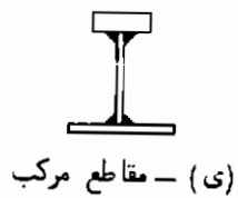
شکل (۵ - ۹) - موارد استعمال متعارف جوش گوشه
