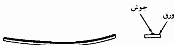
شکل (۵ - ۱۶) - اعوجاج یک تسمه
