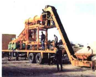
۵۲- یونیت جداسازی الماس از رسوبات
