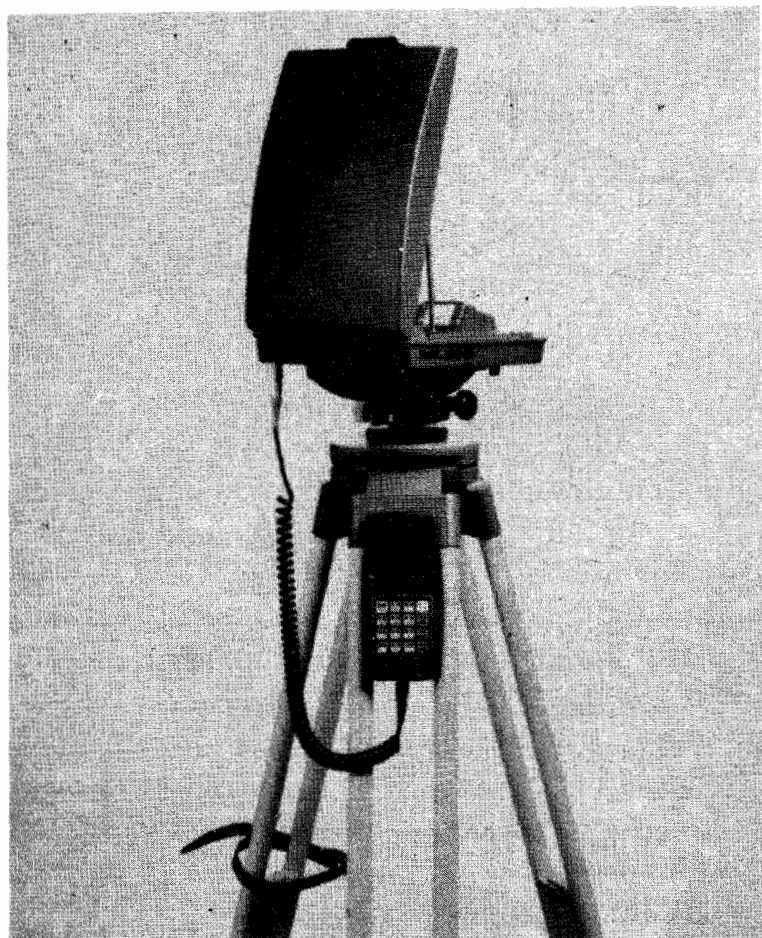
شکل ۲-۴ تومات، یک دستگاه پیشرفته اندازه‌گیری فاصله بر مبنای اصل رادار. در این دستگاه از تابش میکروموج برای اندازه‌گیری فواصلی بین ۲۰ m تا ۲۵ km با دقت ۵ mm استفاده می‌شود. فاصله اندازه گرفته شده مستقیماً به صورت رقمی در روی واحد کنترل دستی ظاهر می‌شوند.
