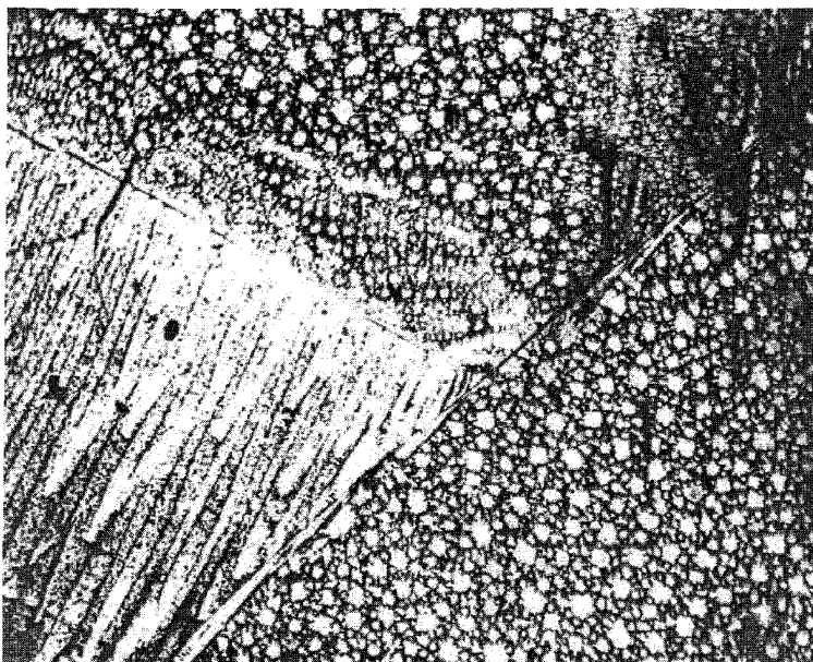
شکل ۹-۲۴ حوزه‌ها و دیوارهای حوزه‌ها در یک بلور فرومغناطیس Si - Fe
