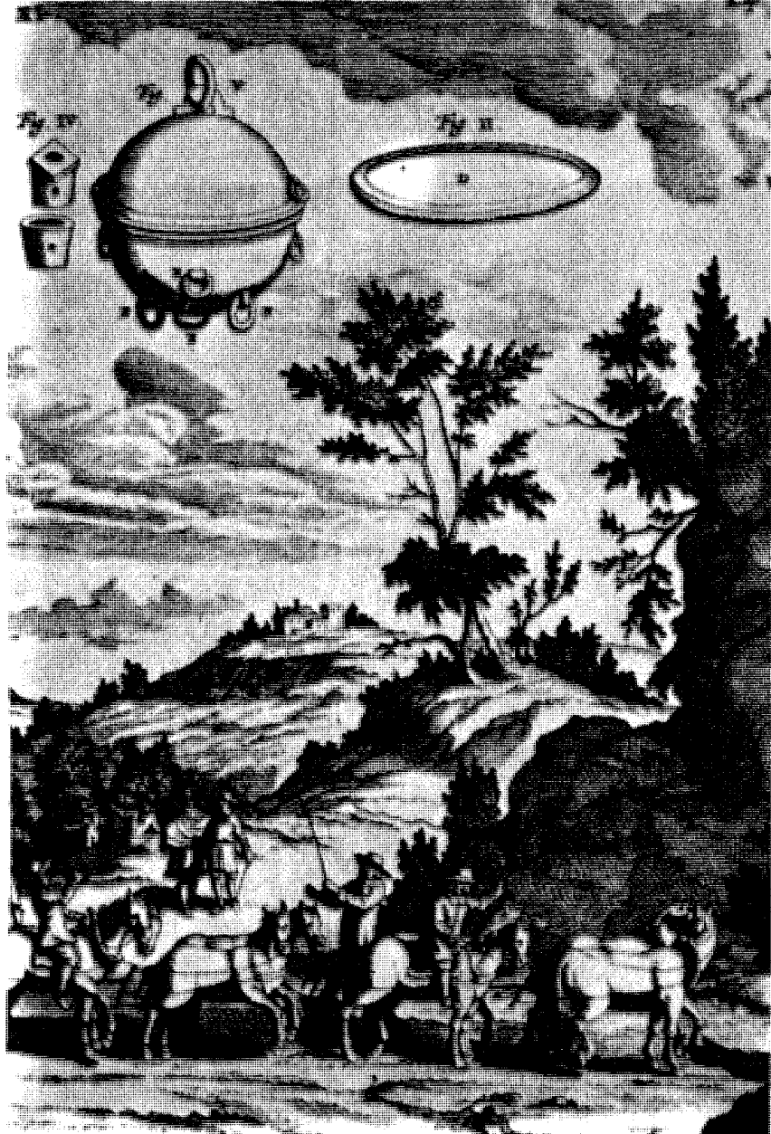
شکل ۹۱- نمایش معروف اتوفون گریکه برای نشان دادن قدرت خلأ. دو دسته اسب، هر یک متشکل از هشت رأس، نمی‌توانستند دو نیمکره را که در میان آنها هوا وجود نداشت از هم جدا کنند؛ اقتباس از آزمایش‌های نوین.
