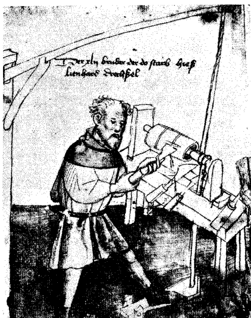
شکل ۳۳- چرخ خراطی کمان‌دار برای تراشیدن دانه‌های تسبیح. میندل‌شن تزولف برودر بوخ، ۱۳۹۰.
