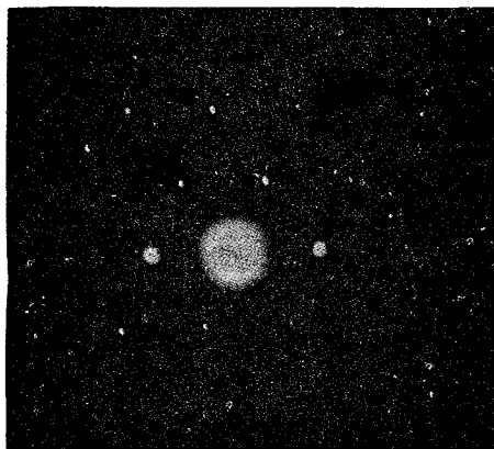
شکل ۲۲۰۱ پراش الکترونهاى 80 \text{ keV} به وسیله تک بلور کربن (گرافیت).
