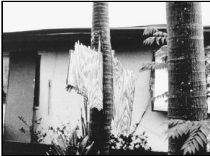
شکل ۳-۸- عبور تخته سه لا از میان تنه نخل سلطنتی به وسیله بادهای فوق العاده شدید هاریکان اندرو در جنوب فلوریدا (NOAA, ۲۰۰۳).
