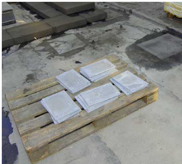
ورق‌های فولادی برای اتصال اعضای سقف.
