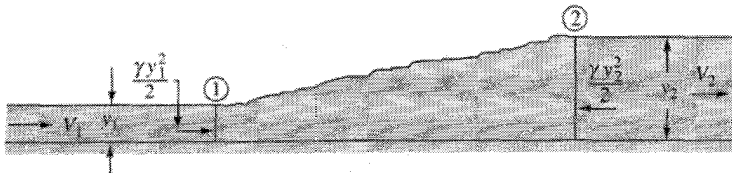
شکل ۴.۱۳ پرش هیدرولیکی در کانال مستطیلی.
