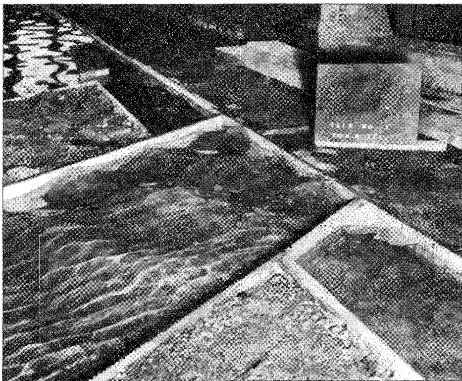
شکل ۴.۵ آزمون مدل در بندرگاه (شعبه مهندسی عمران، دانشگاه میسیگان).
