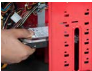
شکل ۴۸- محل نصب دیسک سخت
