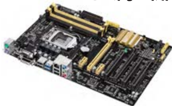
شکل ۸ - برد اصلی با فرم فاکتور ATX
