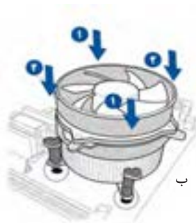
شکل ۳۷- نصب سیستم خنک‌کننده
