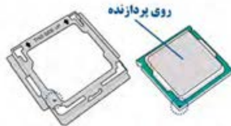
شکل ۳۴- نشانه روی پردازنده و سوکت
