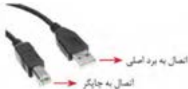
شکل ۱۹- درگاه اتصال USB به چاپگر و کانکتورهای دوسر کابل چاپگر برای اتصال
