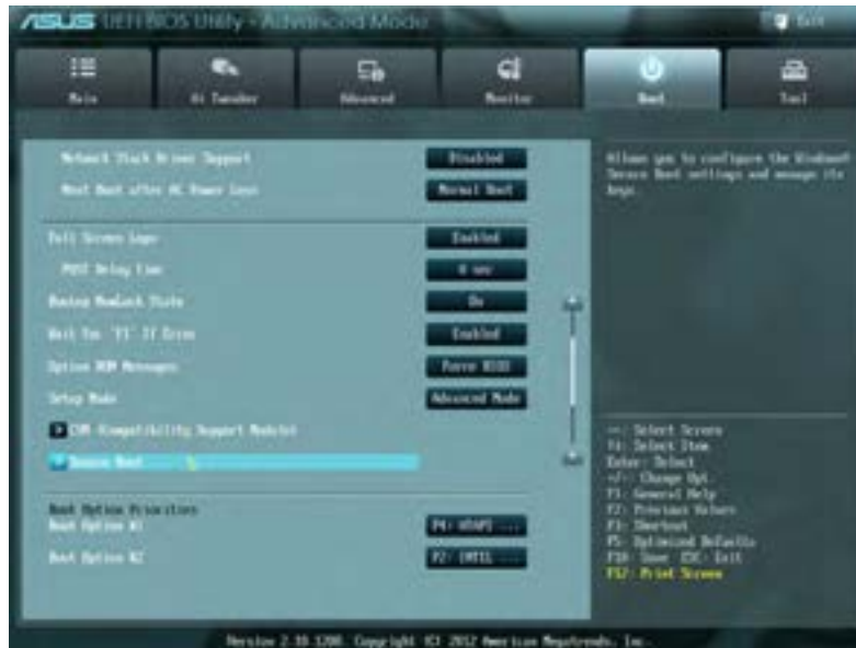
شکل ۵۷- زبانه Boot در UEFI BIOS
