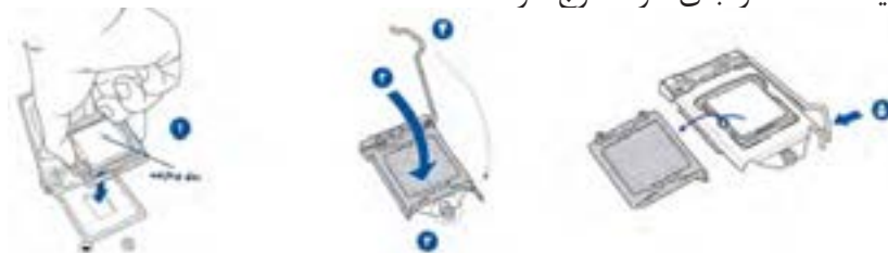
شکل ۳۵- مراحل قراردادن پردازنده در سوکت
