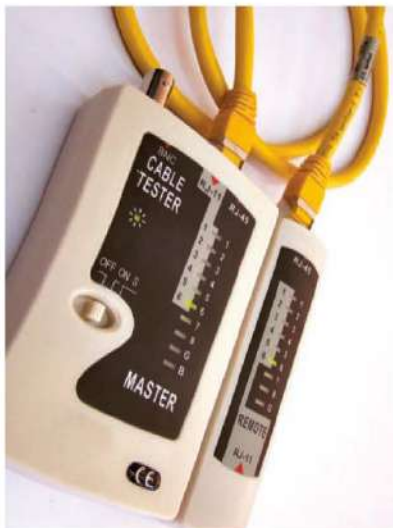
شکل ۲۰- تست کابل شبکه
