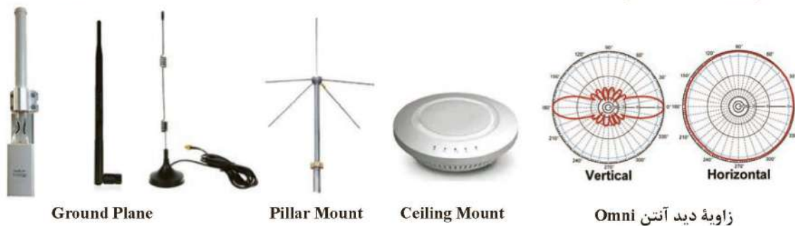
شکل ۲۳- انواع آنتن Omni و زاویه دید آن
