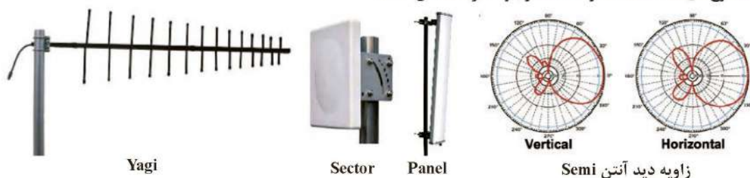
شکل ۲۴- انواع آنتن Semi و زاویه دید آن
