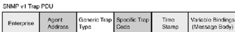
Figure 11.6. SNMP v1 Trap PDU header.
