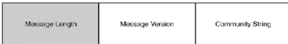
Figure 11.5. SNMP v1 and SNMP v2 data PDU.
